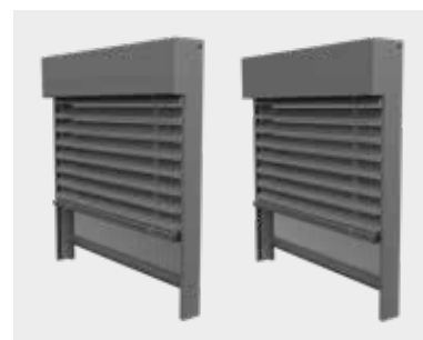
TENDINA SKY-MULTI IR SKY-MULTI A SCOMPARSA IR Varianti di tendina paravento/supporti a scomparsa con zanzariera integrata. Larghezza max. 1800 mm; Altezza max. 2500 mm
