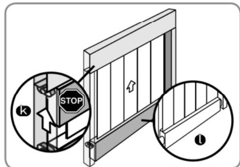
\*Dieser Schritt eignet sich besonders für Behänge vom Typ " ZIP Screen " und jeden anderen Behang mit einem schweren Endstab und einem oberen Stopper.
