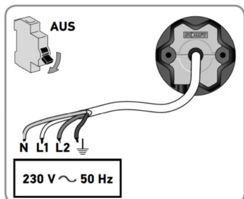
**i** Der Antrieb kann parallel verkabelt werden. In diesem Fall die Maximallast des Schalters oder der verwendeten Steuerung beachten
